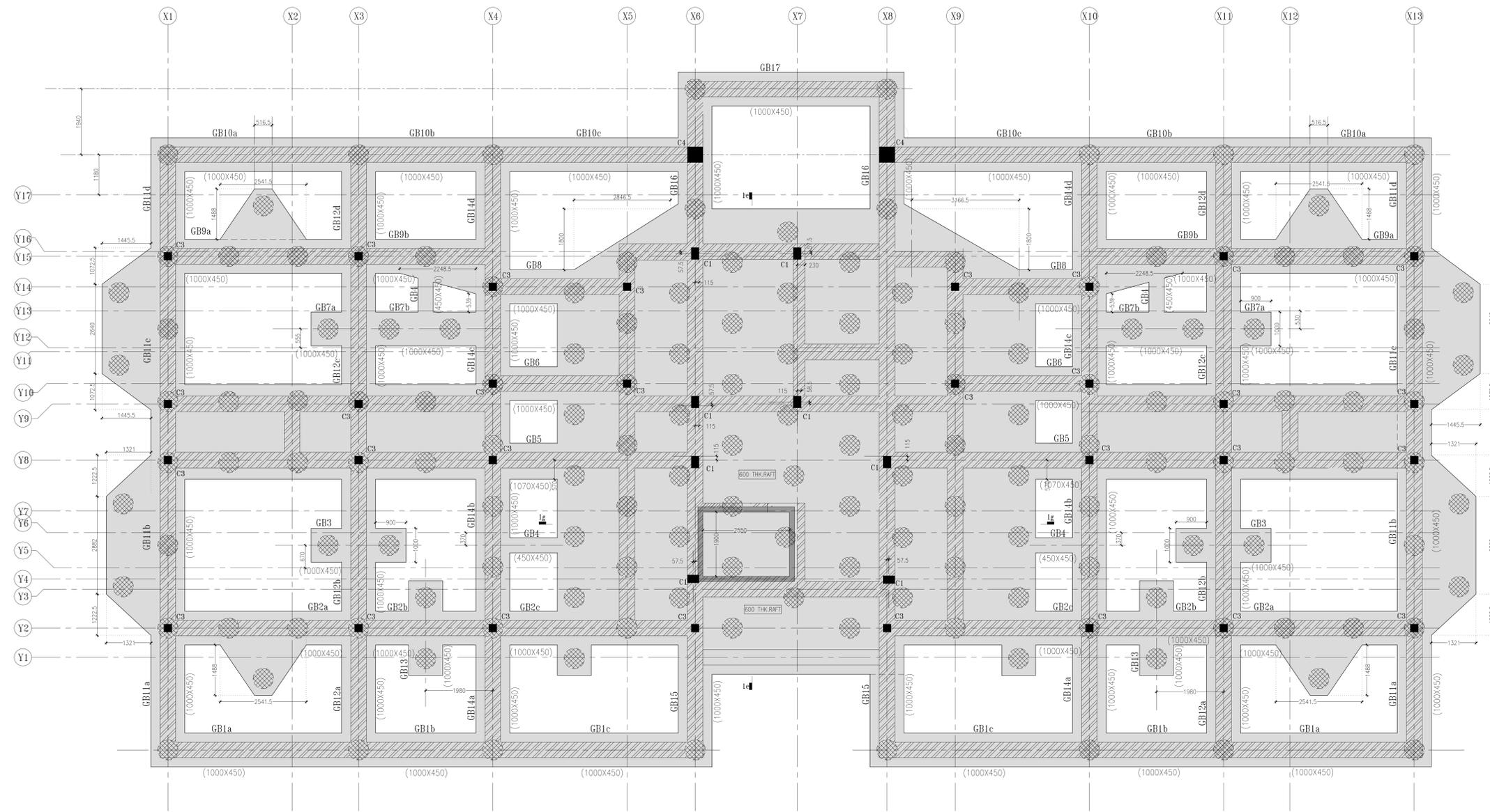
PILE CAP AND GRADE BEAM LAYOUT
