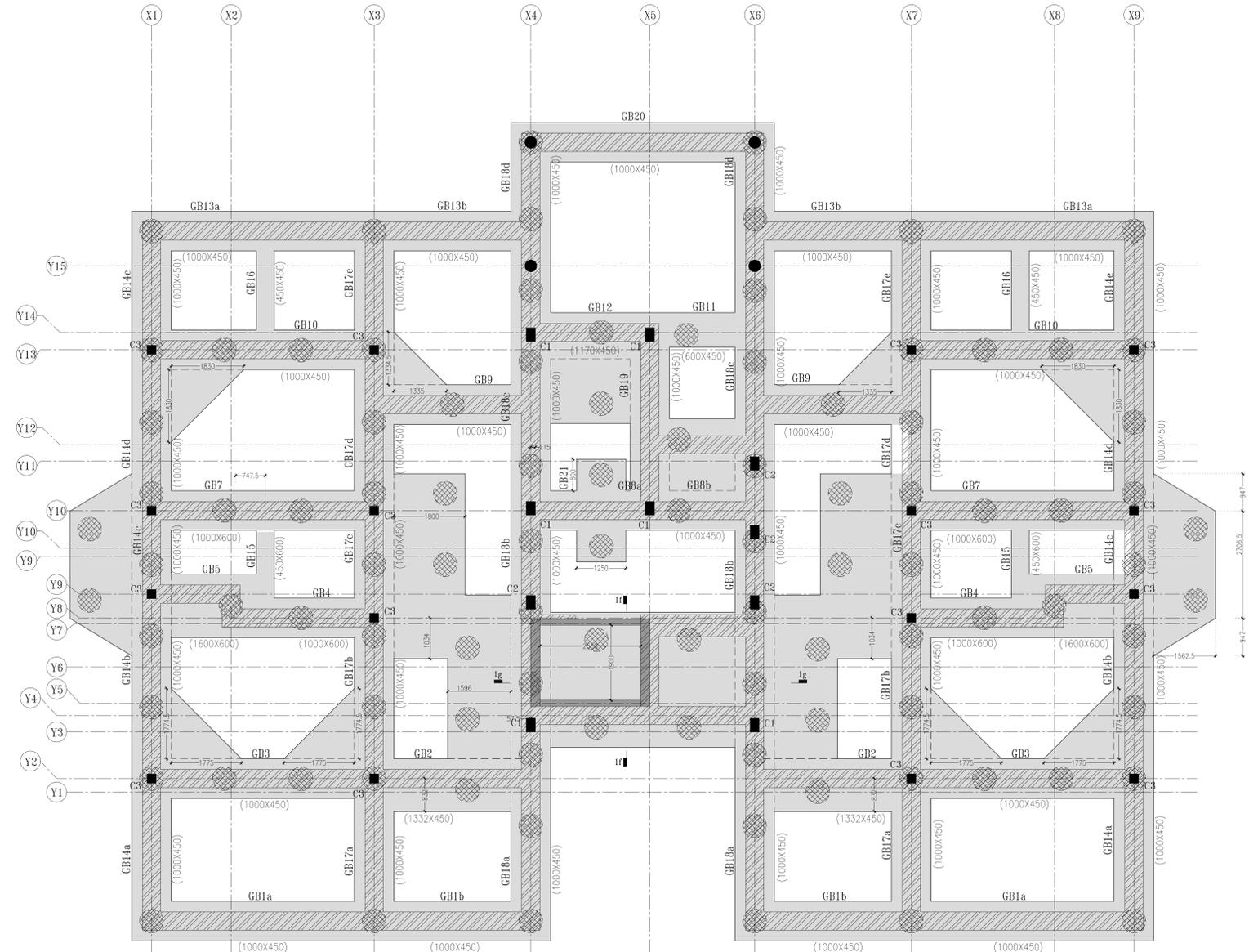
PILE CAP AND GRADE BEAM LAYOUT
