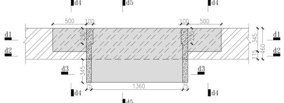
TYP. DETAIL OF JAMB, SILL BAND (S4C) & LINTEL BAND (L4C) FOR WINDOW
